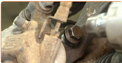
**47** Serrez les fixations du support de l'étrier de frein. Utilisez une douille de 18 mm. Utilisez une clé dynamométrique. Couple de serrage : 175 Nm.
