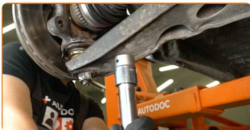
**44** Serrez les boulons de fixation des roulements de roue. Utilisez un embout Torx T50. Utilisez une clé dynamométrique. Couple de serrage : 53 Nm.
