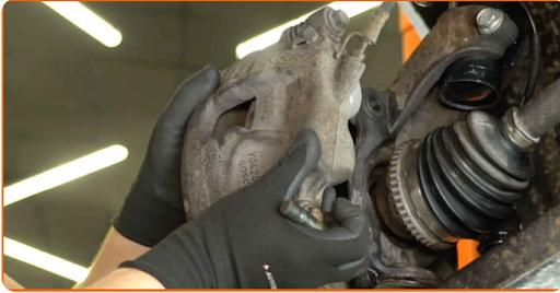
Remplacement : roulement de roue – Ford Transit Mk7 van. AUTODOC recommande :
