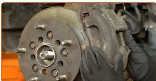
**46** Installez les écrous de fixation.
