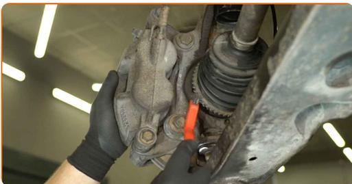
**18** Dévissez les fixations du support d'étrier de frein. Utilisez une douille de 18 mm. Utilisez une barre de force.
