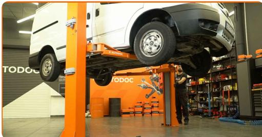
**2** Retirez la courroie Poly-V de la pompe de direction assistée en tournant la poulie du vilebrequin. Utilisez un outil de démontage/montage de courroie extensible. Utilisez un levier de montage. Utilisez une clé mixte de 15 mm.
