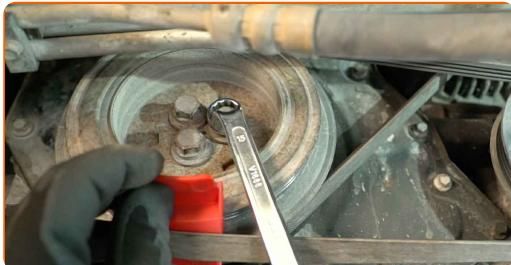
**3** Retirez la courroie Poly-V de l'alternateur en tournant la poulie du vilebrequin. Utilisez un outil de démontage/montage de courroie extensible. Utilisez un levier de montage. Utilisez une clé mixte de 15 mm.
