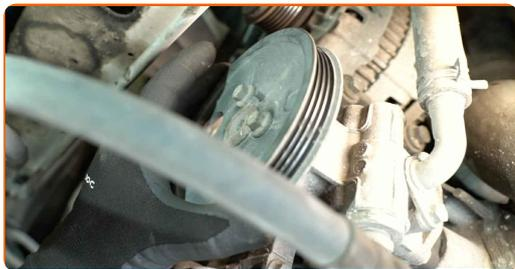
**5** Installez une nouvelle courroie Poly-V d'alternateur en tournant la poulie du vilebrequin. Utilisez un outil de démontage/montage de courroie extensible. Utilisez une clé mixte de 15 mm.
