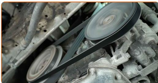
Remplacement : courroie poly V – Ford Transit Mk7 van. AUTODOC recommande :
