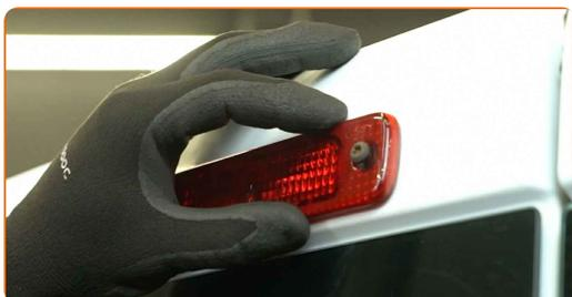
**9** Serrez les vis de fixation du troisième feu stop. Utilisez un embout Torx T25. Utilisez un tournevis à cliquet.
