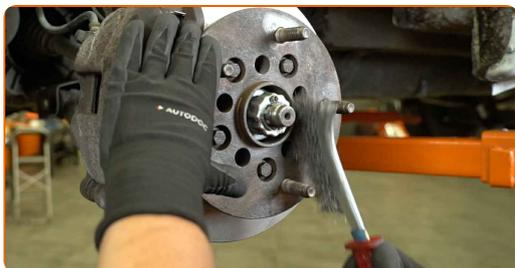
**28** Traitez la surface du moyeu de roue en contact avec la jante de roue. Utilisez de la graisse céramique.
