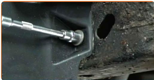
**26** Vissez l'écrou de fixation du couvercle du réservoir du lave-glace. Utilisez une douille d'entraînement de 10 mm. Utilisez une clé à cliquet.
