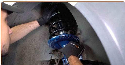
**57** Vissez les fixations supérieures du support de la jambe de suspension. Ne serrez pas trop.
