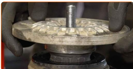
**51** Serrez l'écrou de l'entretoise d'amortisseur due la tige de piston. Utilisez une douille n° 21. Utilisez la clé HEX n° H7. Utilisez une clé dynamométrique. Serrez-le jusqu'à 80 Nm.
