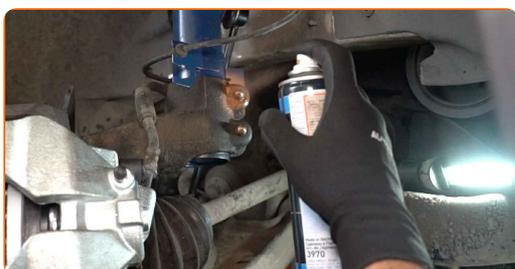
**76** Appliquez du produit sur la zone de contact entre le disque de frein et la jante. Utilisez de la graisse au cuivre.
