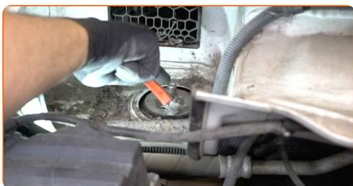
**11** Devisssez la fixation supérieure du support d'amortisseur. Utilisez la clé HEX n° H7. Utilisez une douille n° 21. Utilisez une clé à cliquet.
