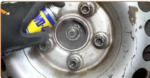
**15** Desserrez la fixation de l'arbre de transmission. Utilisez une douille n° 30. Utilisez un porte-taraud.
