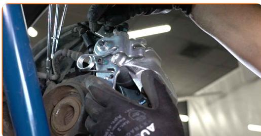
**22** Serrez les fixations de l'étrier de frein. Utilisez une douille n° 12. Utilisez une clé dynamométrique. Serrez-le jusqu'à 35 Nm.
