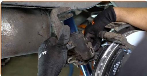
Remplacement : étrier de frein – VW T5 Transporter. AUTODOC recommande :
