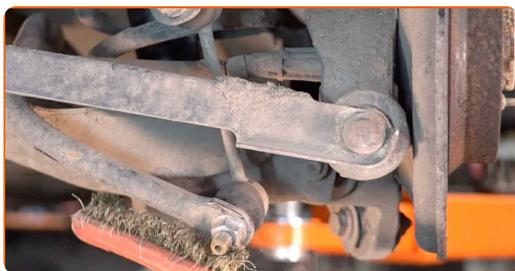
**7** Dévissez les fixations qui relient la biellette à la barre stabilisatrice. Utilisez une douille n° 18. Utilisez une clé à cliquet.
