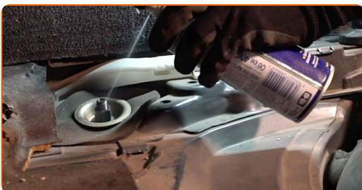
**6** Relâchez la fixation supérieure de l'amortisseur. Utilisez une clé mixte de No.18 Utilisez la mèche Torx T30. Utilisez une clé à cliquet.
