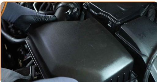
**12** Vissez les trois vis de fixation du couvercle de filtre à air. Utilisez la mèche Torx T25. Utilisez une clé à cliquet.
