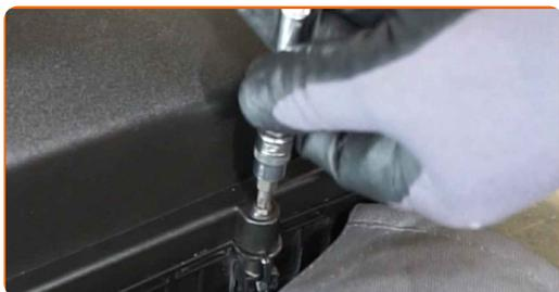
**13** Appliquez du produit sur le débitmètre. Utilisez de la graisse diélectrique.
