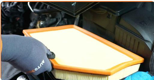
Remplacement : filtre à air – Volvo V70 BW. AUTODOC recommande :
