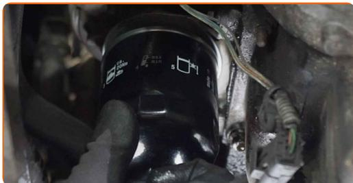
**16** Serrez le filtre à huile. N'oubliez pas de respecter le couple de serrage recommandé. Utilisez la douille 76-14F. Utilisez une clé dynamométrique. Serrez-le jusqu'à 17 Nm.
