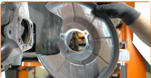
**29** Nettoyez l'emplacement de montage du moyeu de roue. Utilisez une brosse métallique.
