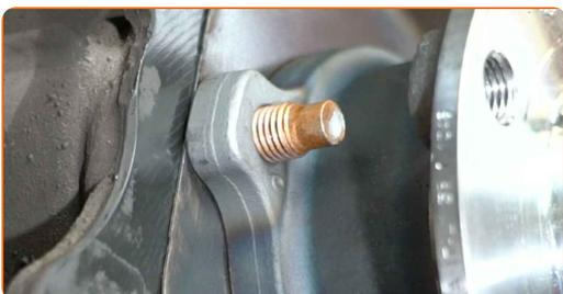
**33** Serrez les fixations du moyeu de roue. Utilisez la mèche Torx T55. Utilisez une clé dynamométrique. Serrez-le jusqu'à 110 Nm.
