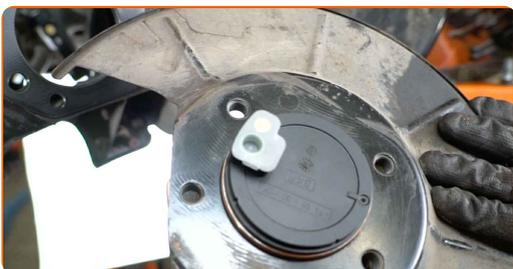
**31** Installez le nouveau moyeu de roue avec le roulement.
