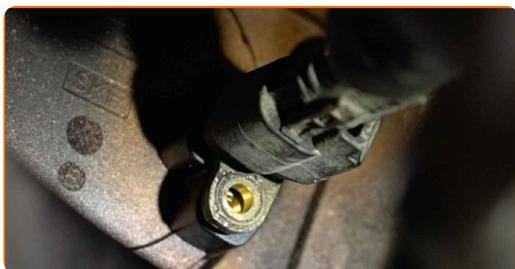
**36** Installez l'écrou de fixation.
