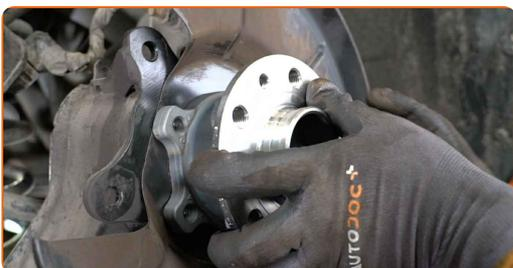
**32** Installez les boulons de fixation.
