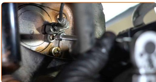
**38** Lubrifiez le moyeu à l'endroit où il est en contact avec le disque de frein. Utilisez du lubrifiant céramique.
