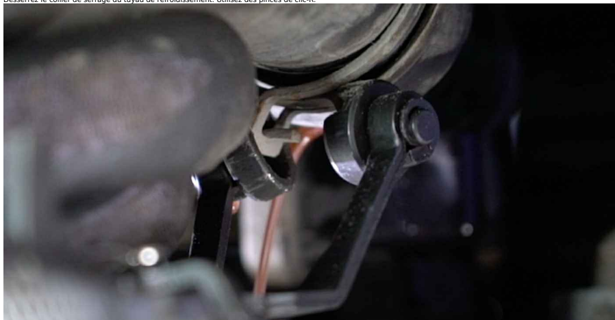
8 Détachez le tuyau de refroidissement.
