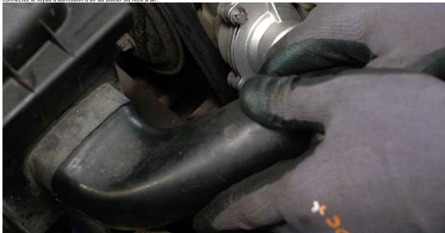
32 Fixez le clip sur le tuyau d'admission du filtre à air.
