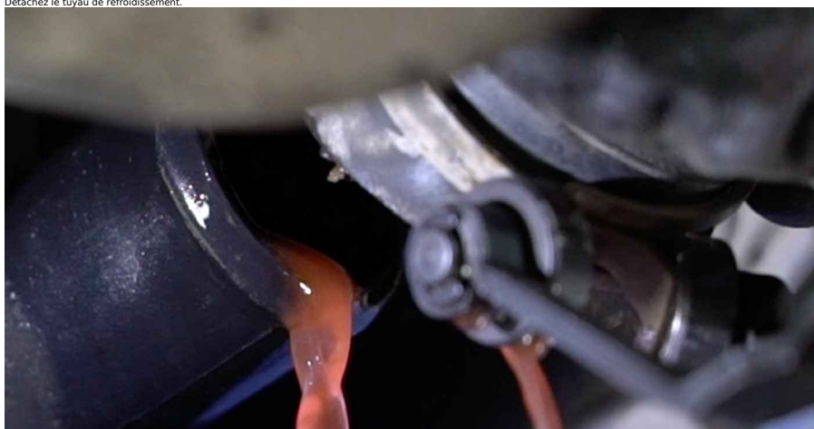
8 Détachez le tuyau de refroidissement.
