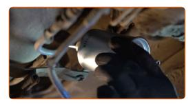
Serrez les attaches du filtre à carburant. Utilisez la mèche Torx T20.
