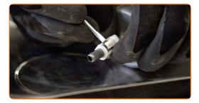
Installez les brides de retenue des fixations des tuyaux du filtre à carburant.
