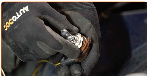
Remplacement : ampoule de phare – VAUXHALL Astra Mk IV (G) Cabriolet (T98). AUTODOC recommande :
