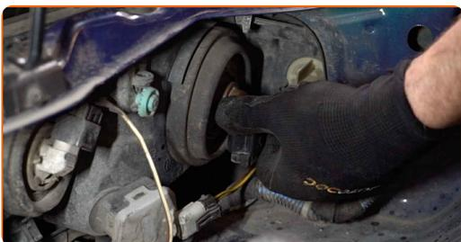
**12** Retirez l'ampoule usagée. Utilisez un tournevis plat.
