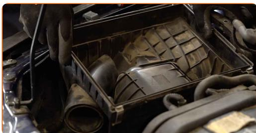
**18** CVissez les boulons de fixation du compartiment filtre. Utilisez la mèche Torx T30. Utilisez une clé à cliquet.
