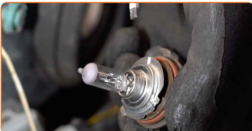
**13** Vérifiez l'état des branchements du porte-ampoule. Remplacez-les si nécessaire.
