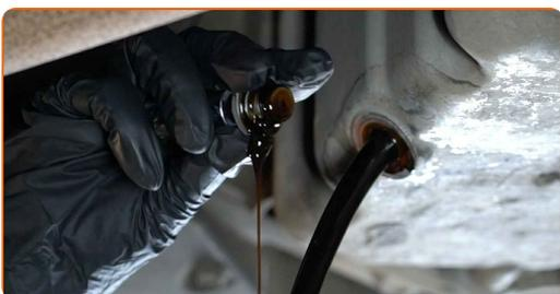
Remplacement : huile moteur et filtre à huile – VAUXHALL Astra Mk IV (G) Cabriolet (T98). Les professionnels recommandent :
