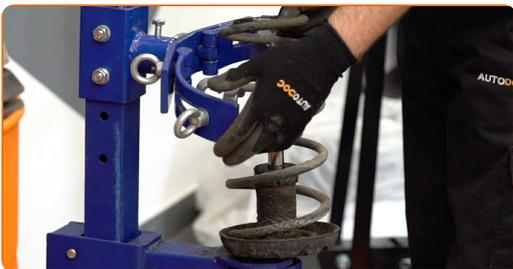
**23** Retirez l'amortisseur usagé du compresseur à ressort hydraulique hélicoïdal.
