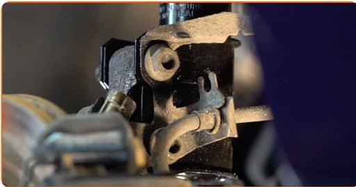
**38** Serrez les fixations inférieures qui relient l'amortisseur à la fusée d'essieu. Utilisez une clé mixte de No.18. Utilisez une douille n° 18. Utilisez une clé dynamométrique. Serrez-le jusqu'à 90 Nm.+45°
