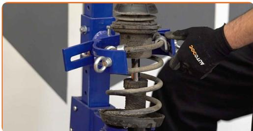
**19** Retirez l'écrou de la tige de piston de l'entretoise. Utilisez une clé mixte de No.19. Utilisez une douille n° 9.
