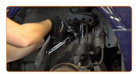
Dévissez la fixation inférieure assurant la connexion entre la jambe d'amortisseur et le porte-fusée. Utilisez une clé mixte de No.18. Utilisez une douille n° 18. Utilisez un porte-taraud.
