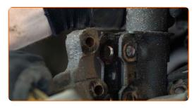
Dévissez l'attache supérieure de l'entretoise de l'amortisseur. Utilisez une clé mixte de No.19. Utilisez une douille n° 9. Utilisez une clé à cliquet.
