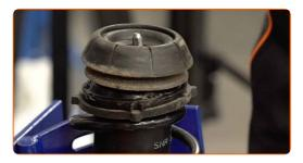
Serrez l'écrou de l'entretoise d'amortisseur due la tige de piston. Utilisez une clé mixte de No.19 Utilisez une douille n° 9. Utilisez une clé dynamométrique. Serrez-le jusqu'à 50 Nm.
