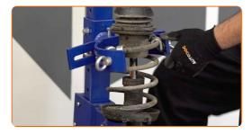
Retirez l'écrou de la tige de piston de l'entretoise. Utilisez une clé mixte de No.19. Utilisez une douille n° 9.
