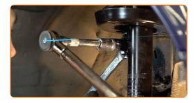
Appliquez du produit sur les fixations de l'amortisseur. Appliquez du produit sur tous les joints du stabilisateur. Utilisez de la graisse au cuivre.
