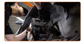
Serrez l'écrou de fixation supérieur de l'entretoise de l'amortisseur. Ne serrez pas trop.
