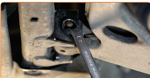
**10** Dévissez l'attache du bras arrière. Utilisez une douille n° 18. Utilisez une clé mixte de No.18. Utilisez une clé à cliquet.
