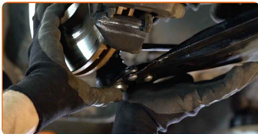
Remplacement : bras inférieur avant – VAUXHALL Astra Mk IV (G) Coupe (T98). AUTODOC recommande :
