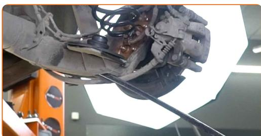
**19** Installez un nouveau ressort hélicoïdal avec ses supports en caoutchouc sur les emplacements de montage.
