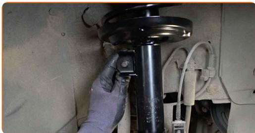
**50** Serrez la fixation reliant la biellette à l'amortisseur. Utilisez une clé mixte de No.17 Utilisez une douille n° 18. Utilisez une clé dynamométrique. Serrez-le jusqu'à 55 Nm.
