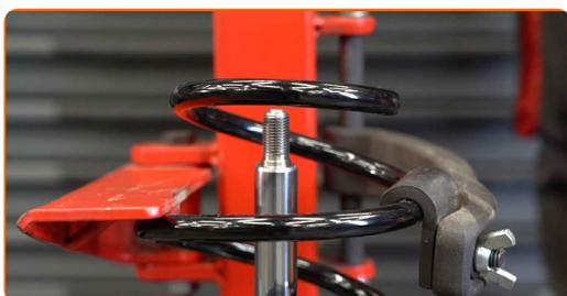
**33** Installez la coupelle, le manchon et la butée de suspension sur l'amortisseur.
