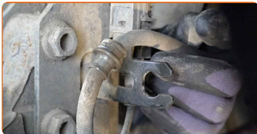
**14** Débranchez les fils du capteur d'ABS.
