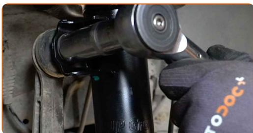
**51** Lubrifiez les fixations de la coupelle d'amortisseur. Appliquez du produit sur les fixations de la fusée d'essieu. Utilisez de la graisse au cuivre.
