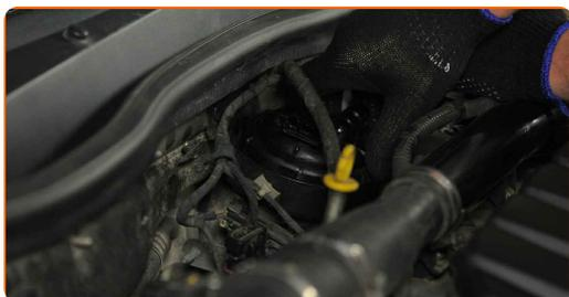
**16** Attachez le tuyau au filtre à carburant.
