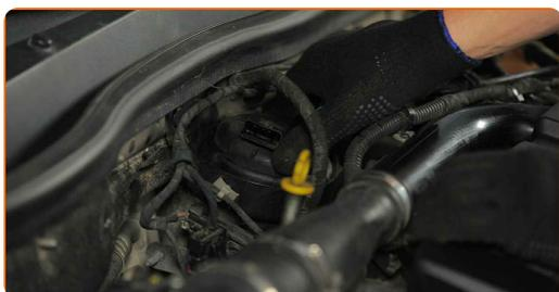
**7** Retirez le couvercle du filtre à carburant sur lequel est montée une vieille cartouche filtrante.
