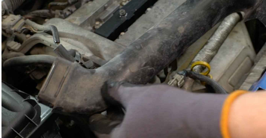
15 Nettoyez les raccords des tuyaux du liquide de refroidissement. Servez-vous d'un aérosol nettoyant multi-usages.
