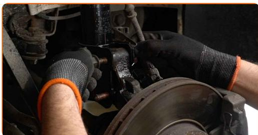
**49** Vissez la fixation qui relie la jambe d'amortisseur à la fusée d'essieu. Utilisez une clé mixte de No.18 Utilisez une douille n° 18. Utilisez une clé à cliquet.
