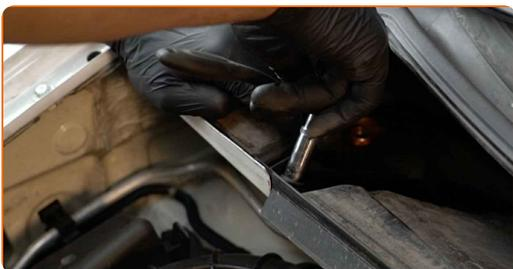
**69** Réinstallez la partie supérieure du tablier d'auvent.
