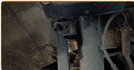
**18** Débranchez les fils du capteur d'ABS.
