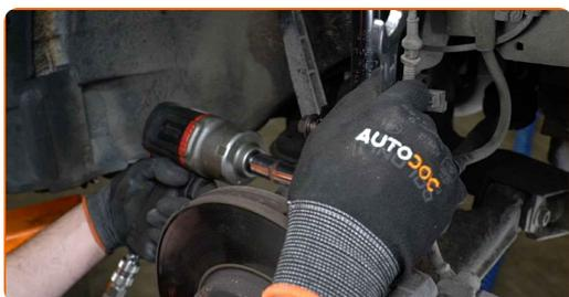
**50** Serrez les fixations inférieures qui relient l'amortisseur à la fusée d'essieu. Utilisez une clé mixte de No.18 Utilisez une douille n° 18. Utilisez une clé dynamométrique. Serrez-le jusqu'à 90 Nm.+45°
