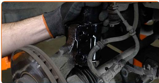
**48** Installez les boulons de fixation.
