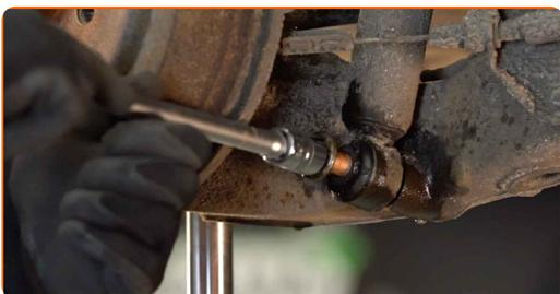
**9** Retirez l'écrou de fixation.
