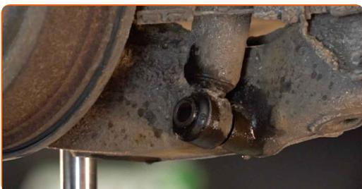
**10** Dévissez l'attache supérieure de l'amortisseur. Utilisez une douille n° E20. Utilisez un porte-taraud.
