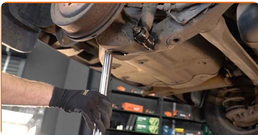
**8** Dévissez l'attache inférieure de l'amortisseur. Utilisez une douille n° E20. Utilisez un porte-taraud.
