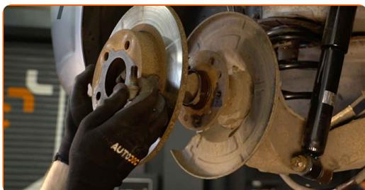
Remplacement : roulement de roue – VAUXHALL Astravan Mk V (H) (A04).
