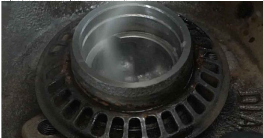
18 Installez une nouvelle bague de roulement de roue extérieure dans le tambour de frein. Coffret de douilles et de roulements.
