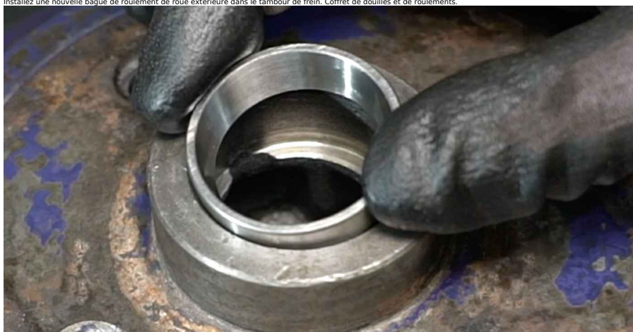
19 Installez la nouvelle bague intérieure du roulement de roue dans le tambour de frein. Coffret de douilles et de roulements.
