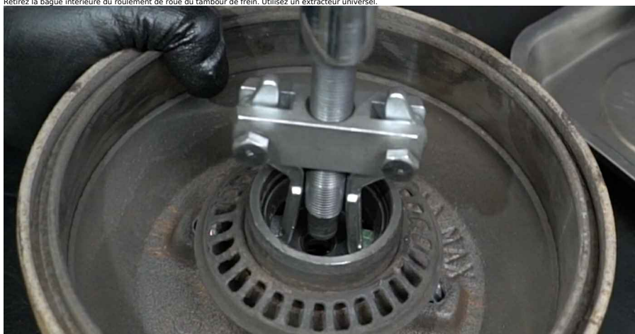
15 Retirez la bague intérieure du roulement de roue du tambour de frein. Utilisez un extracteur universel.
