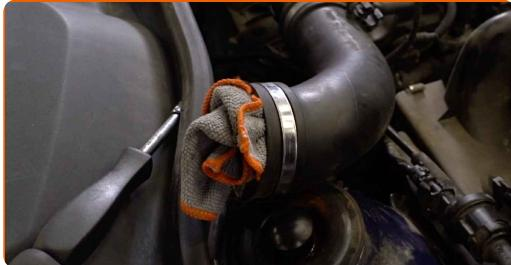
**7** Détachez les fixations reliant le tuyau d'air et le faisceau de câbles au boîtier du filtre à air.
