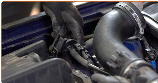
**8** Retirez le couvercle du filtre. Retirez l'élément filtrant du compartiment du filtre.
