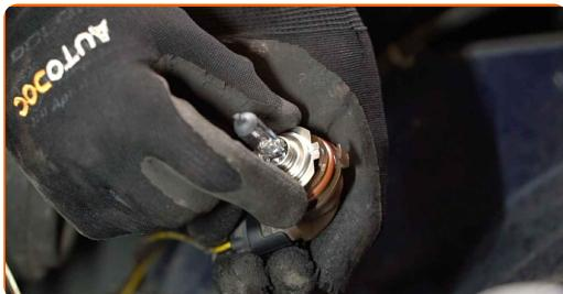
Remplacement : ampoule de phare – VAUXHALL COMBO Mk II (C) Camionnette/Break (F25). AUTODOC recommande :
