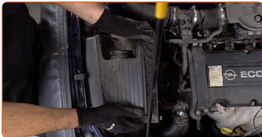
**9** Dévissez les boulons de fixation du compartiment du filtre. Utilisez la mèche Torx T30. Utilisez une clé à cliquet.
