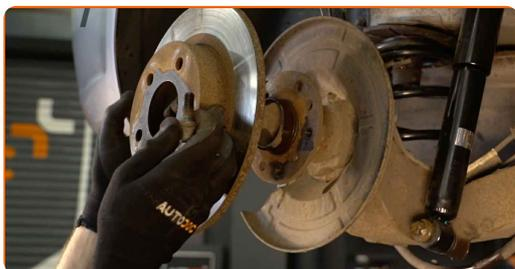
Remplacement : disques de frein – VAUXHALL COMBO TOUR Mk II (C) (F25).
