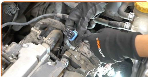
**14** Dévissez les boulons des bobines d'allumage. Utilisez la mèche Torx T30. Utilisez une clé à cliquet.
