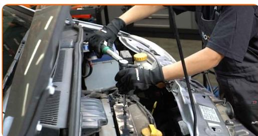
**25** Appliquez du produit sur la bobine d'allumage. Le produit protégera les contacts électriques de la corrosion, de l'oxydation et réduira la résistance des contacts.
