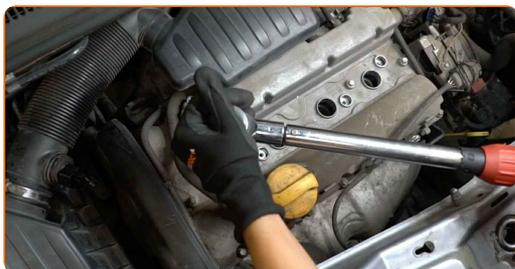
Remplacement : bougies d'allumage – VAUXHALL Corsa Mk I (B) 3/5 portes (S93). Les professionnels recommandent :
