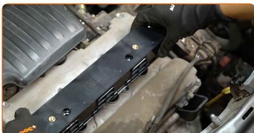
**24** Serrez les boulons des bobines d'allumage. Utilisez la mèche Torx T30. Utilisez une clé dynamométrique. Serrez-le jusqu'à 7 Nm.
