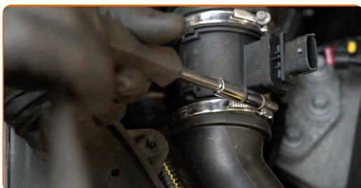
**5** Desserrez les trois vis de fixation du couvercle de filtre à air. Utilisez la mèche Torx T20. Utilisez une clé à cliquet.
