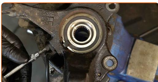
**48** Vissez la fixation reliant le capteur ABS à la fusée d'essieu. Utilisez la clé HEX n° H5. Utilisez une clé dynamométrique. Serrez-le jusqu'à 13 Nm.
