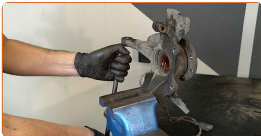
**33** Retirez le moyeu de roue de la fusée d'essieu. Servez-vous d'un poinçon effilé. Servez-vous d'un marteau.
