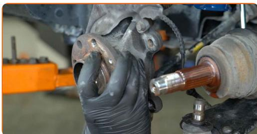
**32** Agrippez le moyeu de roue avec les roulements en vous servant d'un étau.
