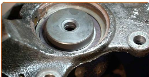
**46** Installez la fusée d'essieu et moyeu dans l'assemblage.
