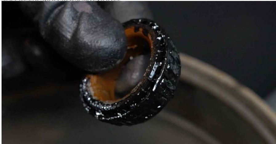
14 Nettoyez l'emplacement de roulement de moyeu.
