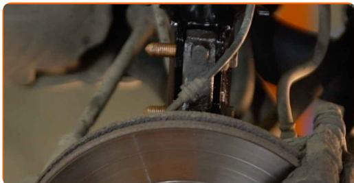
**40** Vissez la fixation qui relie la jambe d'amortisseur à la fusée d'essieu. Utilisez une clé mixte de No.18. Utilisez une douille n° 18.
