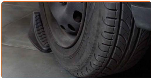
**7** Desserrez les boulons de fixation de la roue. Servez-vous d'une douille à choc pour roue N°17.
