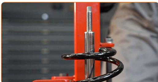
31 Installez la coupelle, le manchon et la butée de suspension sur l'amortisseur.
