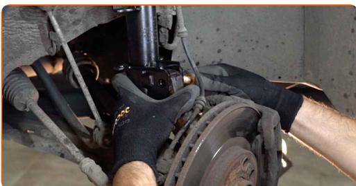
**39** Installez les boulons de fixation.
