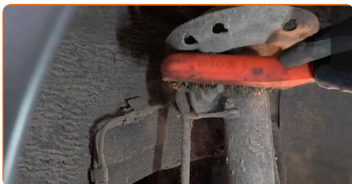
**12** Dévissez la fixation reliant la biellette à l'amortisseur. Utilisez une clé mixte de No.18. Utilisez une douille n° 8. Utilisez une clé à cliquet.
