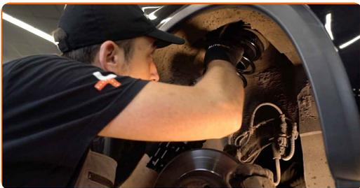
**36** Vissez l'attache supérieure du support de l'amortisseur. Ne serrez pas trop.
