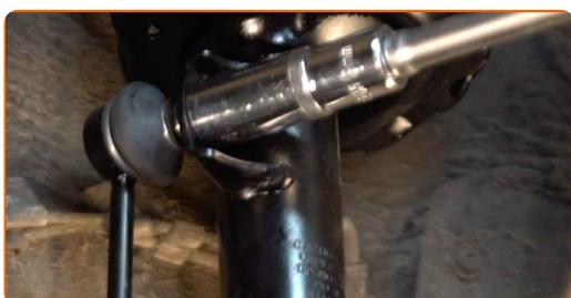
**45** Serrez les fixations inférieures qui relient l'amortisseur à la fusée d'essieu. Utilisez une clé mixte de No.18 Utilisez une douille n° 18. Utilisez une clé dynamométrique. Serrez-le jusqu'à 80 Nm.+60°
