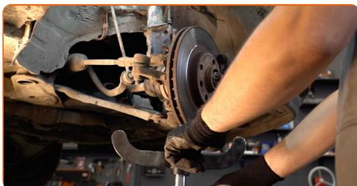
**19** Retirez l'écrou de fixation.
