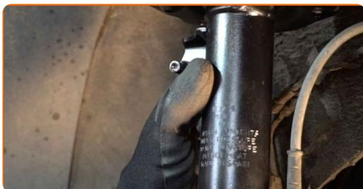
**44** Serrez la fixation reliant la biellette à l'amortisseur. Utilisez une clé mixte de No.18. Utilisez une douille n° 8. Utilisez une clé dynamométrique. Serrez-le jusqu'à 60 Nm.
