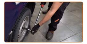
Serrez le montant supérieur de l'entretoise d'amortisseur. Utilisez une douille n° 17. Utilisez une clé dynamométrique. Serrez-le jusqu'à 50 Nm.
