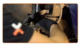
Serrez les fixations inférieures qui relient l'amortisseur à la fusée d'essieu. Utilisez une clé mixte de No.18. Utilisez une douille n° 18. Utilisez une clé dynamométrique. Serrez-le jusqu'à 90 Nm.+45°
