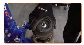
Installez la nouvelle coupelle, le manchon et la butée de suspension sur l'amortisseur.
