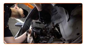
Serrez l'écrou de fixation supérieur de l'entretoise de l'amortisseur. Ne serrez pas trop.
