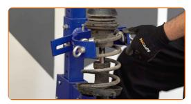
Retirez l'écrou de la tige de piston de l'entretoise. Utilisez une clé mixte de No.19 Utilisez une douille n° 9.
