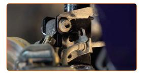
Sécurisez le stabilisateur sur l'entretoise de suspension. Utilisez une clé mixte de No.19. Utilisez une douille n° 18. Utilisez une clé dynamométrique. Serrez-le jusqu'à 65 Nm.
