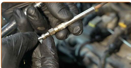
**11** Appliquez du produit sur les bougies de préchauffage. Utilisez la graisse pour injecteurs et bougies de préchauffage.
