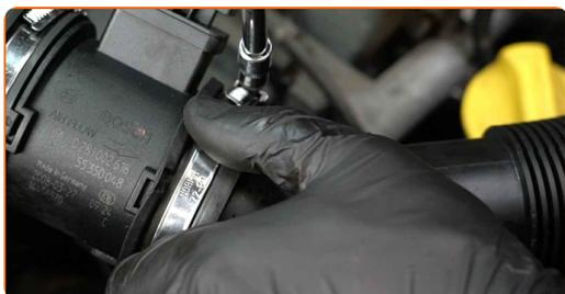
**18** Vissez la fixation sur le tuyau d'entrée d'air. Utilisez la mèche Torx T25.
