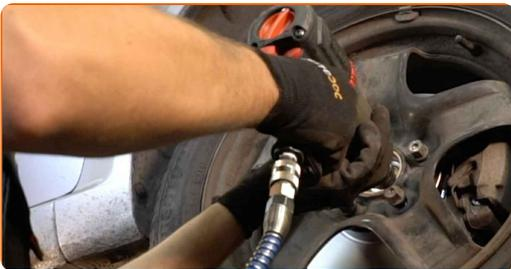
**24** Abaissez la voiture et serrez les boulons de roue en ordre croisé. Servez-vous d'une douille à choc pour roue N°17. Utilisez une clé dynamométrique. Serrez-le jusqu'à 110 Nm.
