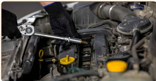
**11** Appliquez une fine couche d'antigrappant à haute température sur les fils des nouvelles bougies d'allumage.
