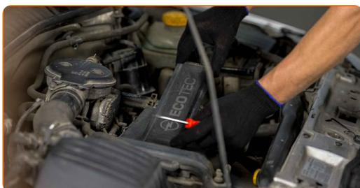
**5** Détachez le raccord de la bobine d'allumage. Utilisez un tournevis plat.
