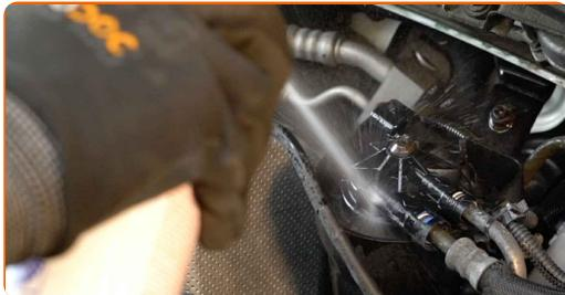
10 Dévissez les fixations du couvercle du boîtier du filtre à carburant. Utilisez la mèche Torx T30. Utilisez une clé à cliquet.
