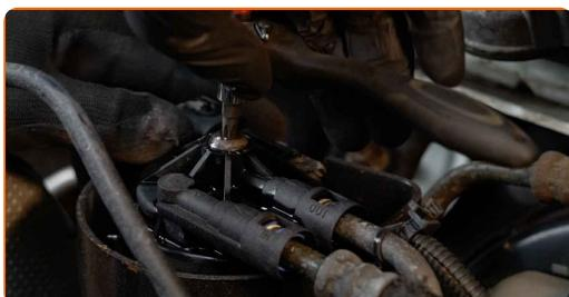
11 Retirez le couvercle du boîtier du filtre à carburant.
