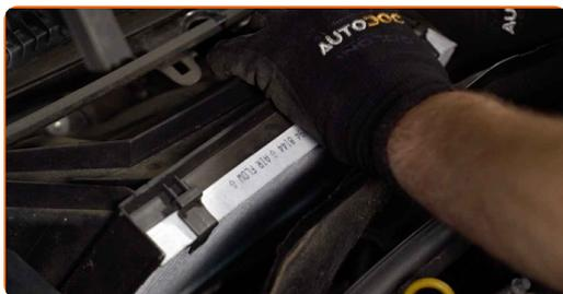
**11** Installez la grille d'auvent sur le côté gauche.
