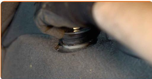
**21** Installez l'écrou de fixation.
