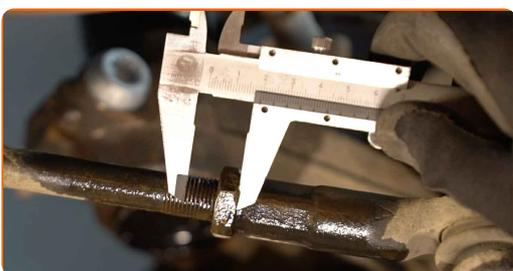
**8** Dévissez l'écrou d'attache d'extrémité à la fusée d'essieu. Utilisez une douille n° 17. Utilisez une clé à cliquet.
