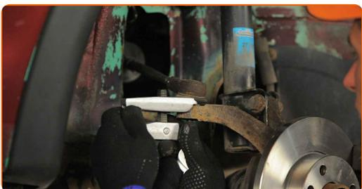
**10** Déserrez l'écrou de blocage qui retient l'extrémité de la barre stabilisatrice à la barre stabilisatrice. Utilisez une clé mixte de No.19
