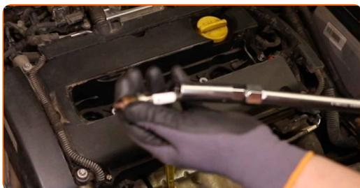
**11** Appliquez une fine couche d'antigrippant à haute température sur les fils des nouvelles bougies d'allumage.
