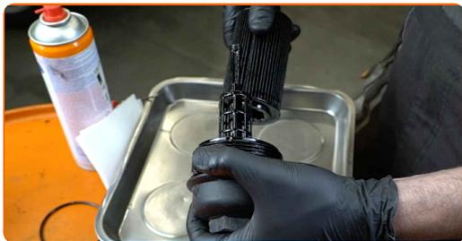
**13** Retirez la bague d'étanchéité du boîtier du filtre à huile. Utilisez un tournevis plat.
