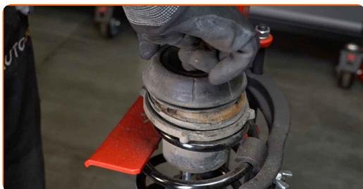
**39** Serrez l'écrou de l'entretoise d'amortisseur due la tige de piston. Utilisez une douille n° 18. Utilisez la clé HEX n° H6. Utilisez une clé dynamométrique. Serrez-le jusqu'à 50 Nm.
