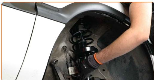
**43** Vissez l'attache supérieure du support de l'amortisseur. Ne serrez pas trop.
