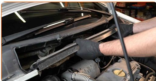
**66** Vissez les fixations de la partie inférieure du tablier d'auvent. Utilisez une douille n° 10. Utilisez une clé à cliquet.
