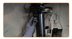
Serrez la fixation reliant la biellette à l'amortisseur. Utilisez une clé mixte de No.17 Utilisez une douille n° 18. Utilisez une clé dynamométrique. Serrez-le jusqu'à 55 Nm.
