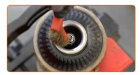
Retirez l'écrou de la tige de piston de l'entretoise. Utilisez la clé HEX n° H7. Utilisez une douille n° 21. Utilisez une clé à cliquet.
