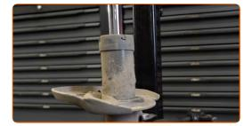
Remplacement : jambe de suspension – VAUXHALL ZAFIRA Mk III (P12). Les experts d'AUTODOC recommandent :
