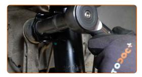
Lubrifiez les fixations de la coupelle d'amortisseur. Appliquez du produit sur les fixations de la fusée d'essieu. Utilisez de la graisse au cuivre.
