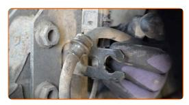
14 Débranchez les fils du capteur d'ABS.
