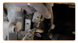
Nettoyez les fixations assurant la connexion entre la jambe d'amortisseur et le porte-fusée. Utilisez une brosse métallique. Servez vous de l'aérosol WD-40.
