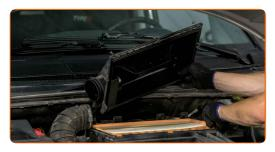
Retirez l'élément filtrant du compartment du filtre.
