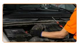
Serrez le collier de serrage sur la durite d'admission d'air. Utilisez un tournevis plat.
