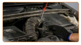
Déconnectez le tuyau d'admission d'air du boitier du filtre à air.
