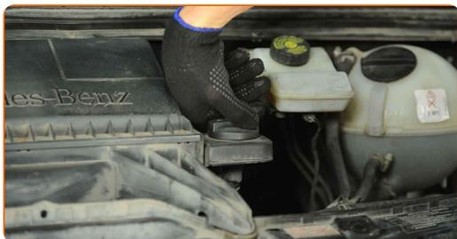
**22** Retirez le bouchon du bec de remplissage d'huile.
